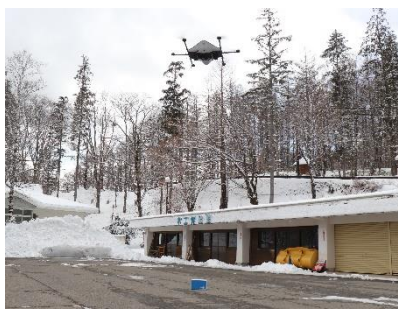
災害を想定した医療物資を搭載した箱を切り離して飛び去る物流専用ドローン AirTruck（おんたけ休暇村）
